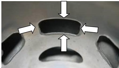
Sur le cylindre 223994, le bord supérieur et inférieur du transfert avant peut présenter quelques traces d'usinage.
