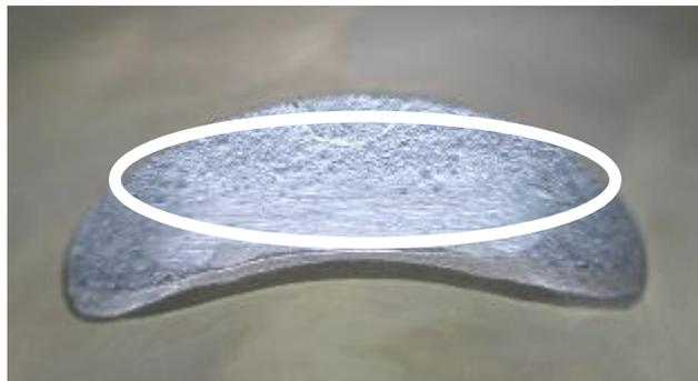
La lumière d'échappement peut présenter quelques traces de meulage manuel faites par le fabricant afin d'éliminer les légers défauts de moulage et d'éliminer les bavures de NIKASIL situées à la fin de la surface traitée au NIKASIL
