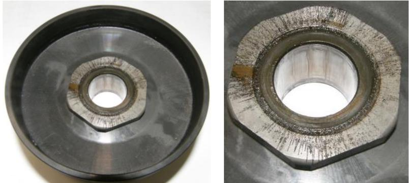
Les photos montrent le maximum de dépôt de graisse pouvant être centrifugé dans la cloche même avec le joint de cloche d'embrayage monté. Seul l'écrou de cloche et l'alésage du pignon montrent des traces de graisse. La surface de frottement des masselottes dans la cloche doit être complètement sèche.
