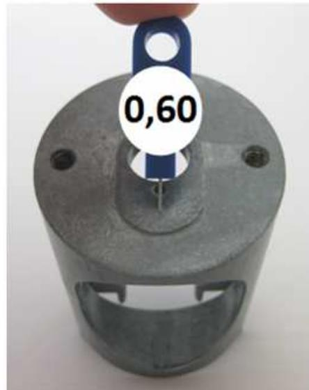
Une jauge de contrôle de 0,90mm ne doit pas entrer dans le trou vertical.
