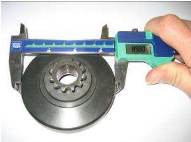
Le diamètre doit être mesuré avec un pied à coulisse positionné en appui sur la cloche (et non du côté ouvert de la cloche).
