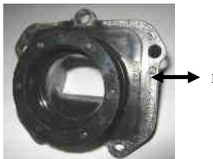
6.2 La boîte à clapet est équipée de 2 déflecteurs et de 2 clapets, chaque clapet se compose de 3 lamelles.
