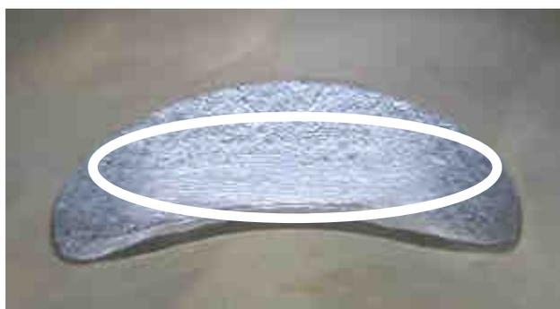
La lumière d'échappement peut présenter quelques traces de meulage manuelles faites par le fabriquant afin d'éliminer les légers défauts de moulage et d'éliminer les bavures de NIKASIL situées à la fin de la surface traitée au NIKASIL.
