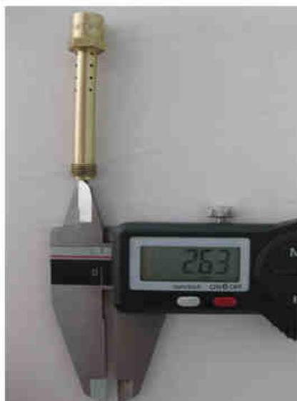
Une jauge de 0,90mm ne doit pas pouvoir entrer dans les 16 trous transversaux.
