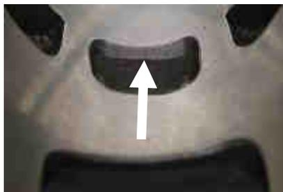
5.7 La partie supérieure du collet d'échappement peut présenter quelques traces d'usinage du fabricant.
