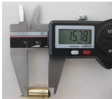
La dimension du décroché (voir photo) doit être de 6mm +/- 0,15mm.
