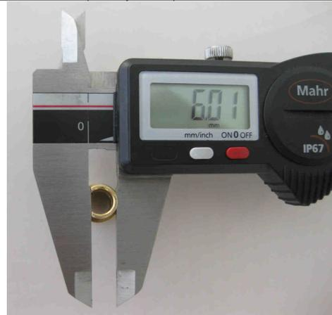
Le diamètre du trou transversal doit être de 4,05 +/- 0,15mm.
