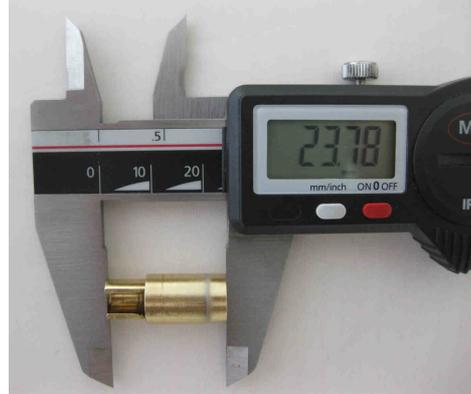
La longueur de la partie cylindrique du diffuseur doit être de 15,75mm +/- 0,25mm
